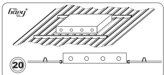
Установка светильника 600x600. Необходимо обеспечить зазор между панелью и светильником - панель не ставить враспор, она должна свободно располагаться на посадочном месте
