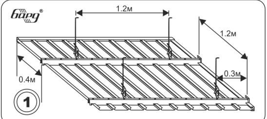
Максимальные размеры для разметки потолка. Стрингеры должны быть установлены строго параллельно друг к другу
