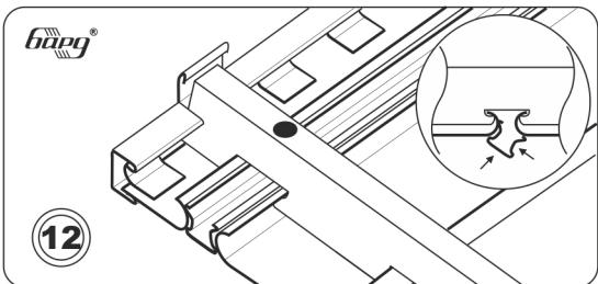
Установить резаную панель с надетым на нее торцевым профилем. Для дополнительной фиксации резаной панели в торцевом профиле можно использовать фрагменты отрезанных частей или скжатый межпанельный профиль.
