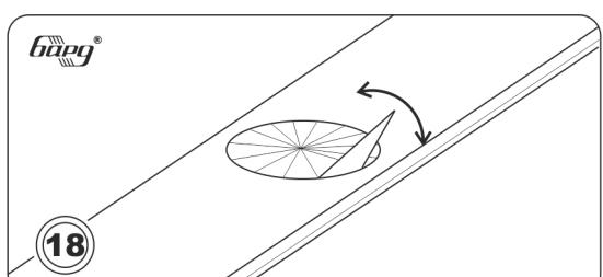
Врезка светильников R50. На панели (или на двух) вырезается окружность ножом по шаблону. После очерчивания окружности ножницами от центра к краям вырезаются сектора. Далее, чтобы избежать коробления панели, каждый из секторов отгибаётся и отламывается. Чем больше секторов, тем ровнее получится вырезанный круг.
