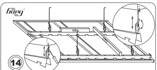
Регулировка высоты производится передвижением регулировочных пружин по спицам или с помощью саморезов (глубиной ввинчивания саморезов). Контроль производится водяным уровнем. На этом этапе важно сразу сделать разметку на панелях под светильники, чтобы не забыть об этом во время набора панелей.
