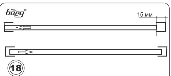
2-й способ: при меньшей длине панели, она укорачивается на глубину торцевого профиля (15 мм). Далее один край панели до упора заводится в торцевой профиль и обратным движением установить панель и защелкнуть на посадочном месте.
