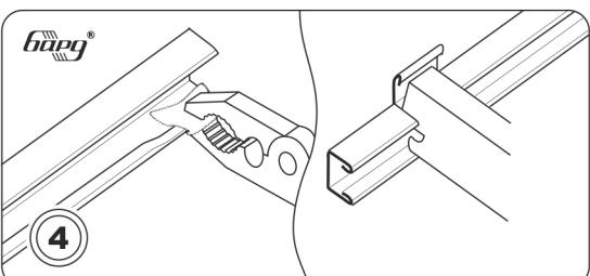
Углы нижней полки торцевого профиля поджать пассатижами через мягкую прокладку 1.5 см. Верхнюю полку в местах сопряжения со стингерами подрезать и отогнуть наверх
