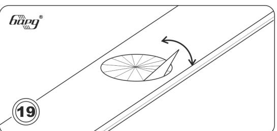
Врезка светильников R50. На панели (или на двух) вырезается окружность ножом по шаблону. После очерчивания окружности ножницами от центра к краям вырезаются сектора. Далее, чтобы избежать коробления панели, каждый из секторов отгибается и отламывается. Чем больше секторов, тем ровнее получится вырезанный круг.
