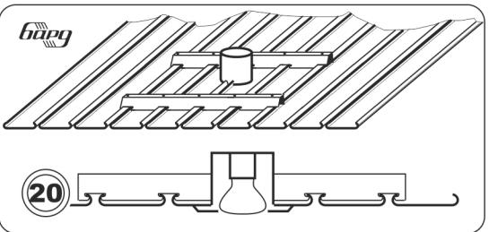
Светильник может устанавливаться и в две панели. Полукружности в каждой из двух панелей вырезаются таким же способом.
