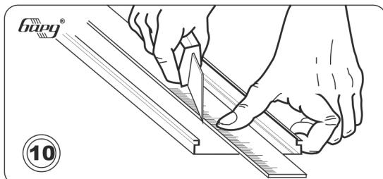
Разрезать панель вдоль по проведенной линии, несколько раз сильно провести ножом по месту реза
