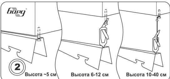
Варианты крепления стингеров: длинным саморезом с зазором для регулировки высоты, на пружине и на пружине со спицей
