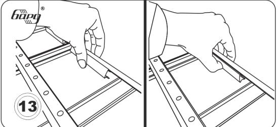
Для дополнительной фиксации резаной панели, а также торцов панелей в торцевом профиле нужно использовать специальные фиксаторы.
