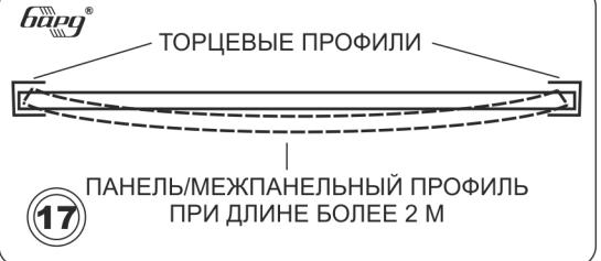
Установка последней панели в потолке. 1-й способ: при длине панели более 2 м, завести один край панели в торцевой профиль до упора, немного согнуть ее из плоскости вниз и вставить в торцевой профиль у противоположной стены.
