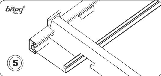
Первая панель, установленная на несущей системе из стингеров. Используйте фиксаторы для панели.
