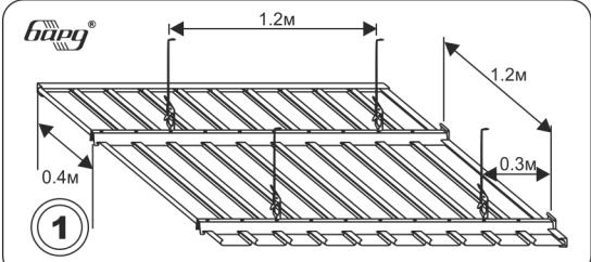
Максимальные размеры для разметки потолка. Стингеры должны быть установлены строго параллельно друг к другу
