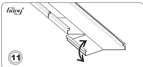
Чтобы избежать коробления панели, ту часть ее, которая будет отрезана, разрезать ножницами на куски 30 см, и поочередно отгибая куски в разные стороны (вверх-вниз), отламывать их.
