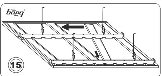
Установка оставшихся панелей. Каждую панель подрезать на 3-5 мм меньше реального размера помещения в данном месте. Вводить панель в два торцевых профиля, расположив ее по диагонали к торцевым, параллельным стрингерам. Выпрямить панель и аккуратным нажатием застегнуть ее на посадочном месте.
