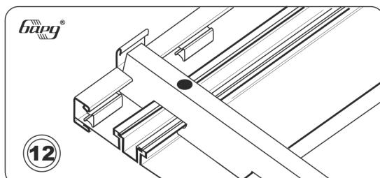
Установить резаную панель с надетым на нее торцевым профилем. Используйте фиксаторы для резаной панели.
